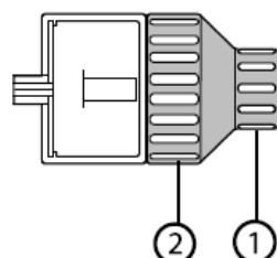
ソニックフレックスのチップ交換を安全に行うためにトルクレンチを使用します。トルクレンチ後部の細いグリップ部①をつまんで簡単にねじ込むことができます。締め付けまたは取り外しの際は、大径部②をつまみます。
