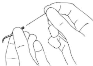
中程度の硬さの歯ブラシなどを使って流水下で、あるいは 60~70% イソプロピルアルコール溶液を使ってソニックフレックスチップの汚れを落とします。チップの先端部は、60~70% アルコール溶液または消しゴムで汚れを落とします。必要に応じて、クリーニング用ノズルニードルを使ってチップの水路を清掃します。
