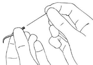
中程度の硬さの歯ブラシなどを使って、流水下でソニックフレックスチップの汚れを落とします。チップの先端部は、消しゴムで汚れを落とします。必要に応じて、クリーニング用ノズルニードルを使ってチップの水路を清掃します。
