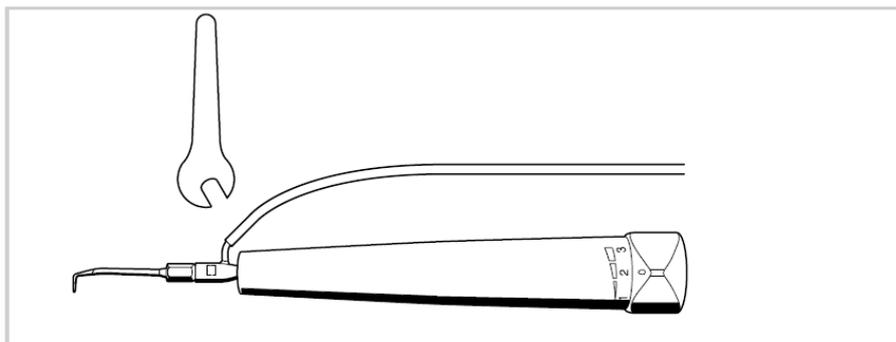
滅菌冷却液を使用する場合は、冷却注水アダプタ用レンチを使ってインストゥルメントに冷却注水アダプタを取り付けます。これにより、ユニットからの水供給は自動的に停止します。トルクレンチを使って、使用するチップを冷却注水アダプタに取り付けます。
