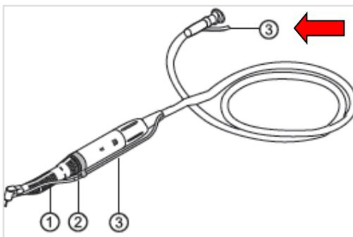
新しいロングシリコンホースを中継マルチカプリングと利用し、赤矢印のポイントで既存のシリコンホースと接続します。
