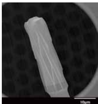
2158(ストレートドーム)のSEM像。ピラミッド型でユニークな幾何学模様のブレードが確認できる。
