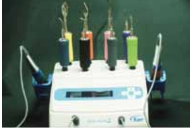
ウルトラワクサー2。左右のペンは独立した温度設定が可能である。
