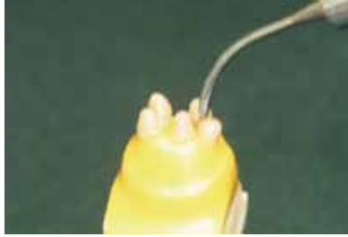
PKT: スモールとラージがあり、ワックスコーンなどを立てる作業などに使用される。
