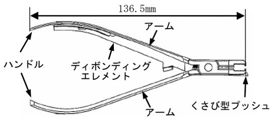
原理：先端でブラケットを保持し、ハンドルを握ると先端のくさび型プッシュが押し進み、ブラケットをはがす。
