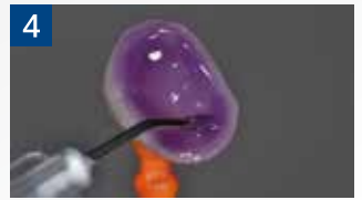
4 サンドブラスト処理後、ゲルエッチャントで酸処理、水洗、乾燥。
