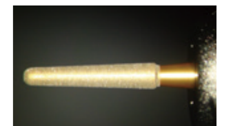
40,000回転時 (5倍速) 最高回転時でも芯ブレがない (写真提供:セントラル歯科医院 高橋 由先生)
