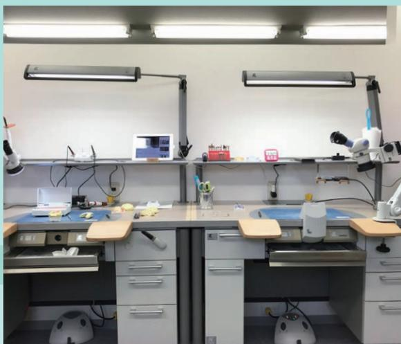
KaVoデスクに変えて改善された点としては、机の上に余計なバキュームのホースやハンドピースのケーブルを置く必要がなくなり、大変すっきりしました。またアームレストがあることで、よりハンドピースと技工物をしっかりホールドできる点は、ミクロン単位の精密な補綴物を要求される作業には大変ありがたいです。さらに作業姿勢が改善され、作業効率が向上し、体への負担を感じにくくなったと思います。加えてバキュームマウスの位置が切削範囲にあるため、ストレス無く作業ができる点もうれしいです。
