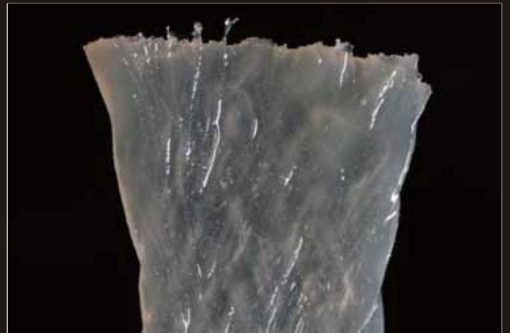
2 コンストラクトリボン2mmにコンストラクトレジンライトを浸透させた拡大写真。
