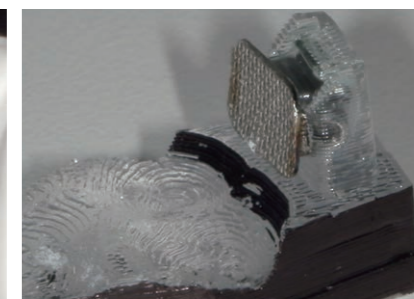
図8 オリジナルのジグ ジグとブラケットベースが近接している。
