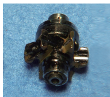
オイル不足でローターが黒く焦げ付きチャック部分も破損
